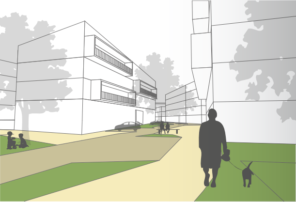
Obytná ulice: zalomená linie, smíšená pozemní komunikace - třídy obytná zóna, šikany tvořené parkovacími plochami, stromy a posezení, fasády členěné balkóny a lodžiemi
